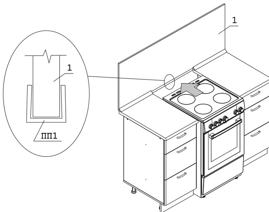
**Внимание!** Во избежание расслоения стеновой панели при эксплуатации перед установкой приставной духовой печи на торец стеновой панели установить торцевую планку «ПП1» 600 мм. Торцевую планку клеить на силиконовый нейтральный герметик.
